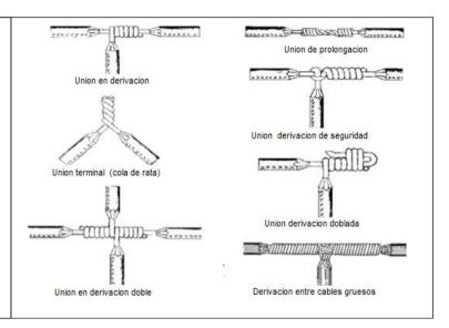
De todas estas conexiones, las más utilizadas en una instalación son las de tipo terminal (cola de rata y pata de gallo)
