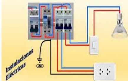
La función de sus dispositivos es controlar la instalación eléctrica y proteger tanto a las personas como a los aparatos que haya conectados a la red, como luminarias, artefactos y máquinas.
