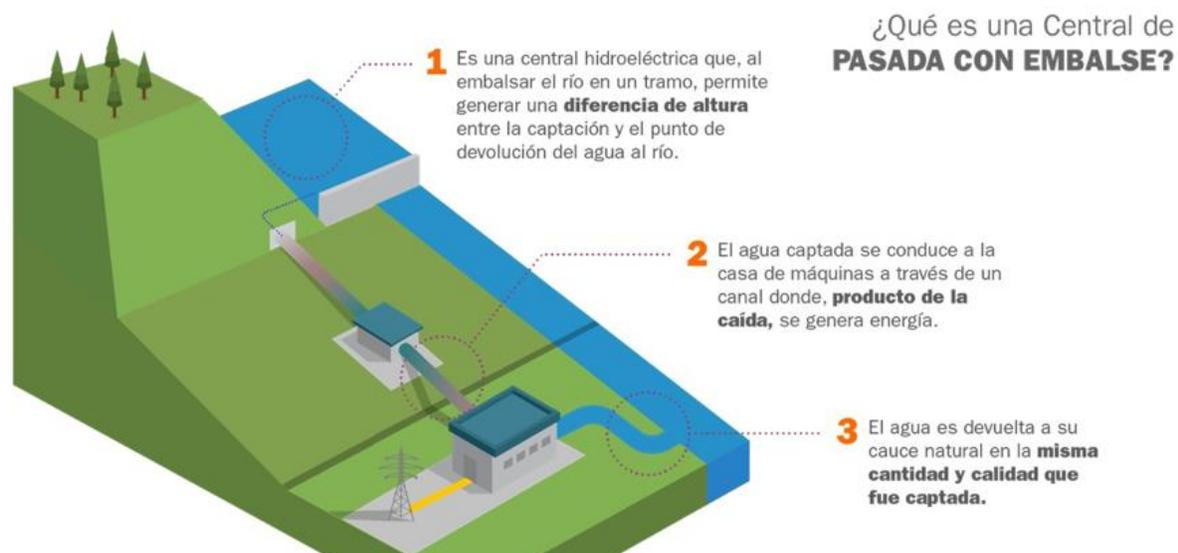
**Centrales hidroeléctricas:** Utilizan la fuerza y velocidad del agua corriente para hacer girar las turbinas. Las hay de dos tipos: de pasada (que aprovechan la energía cinética natural del agua corriente de los ríos) y de embalse (el agua se acumula mediante represas, y luego se libera con mayor presión hacia la central hidroeléctrica).
