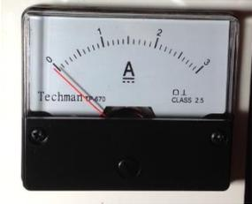
**Transforman** una magnitud, normalmente la corriente eléctrica, en la desviación de una aguja en un visor con escala graduada. Se basa en un efecto bien conocido de la electricidad: el efecto magnético de un electro-ímán, similar al que actúa en un motor eléctrico.
