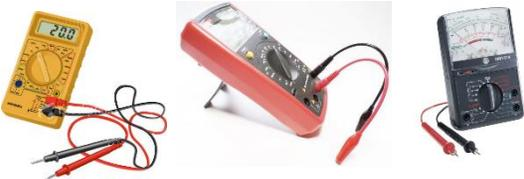
Los instrumentos de la figura se utilizan para medir el valor de magnitudes eléctricas en algún punto de un circuito sin alterar su funcionamiento.
