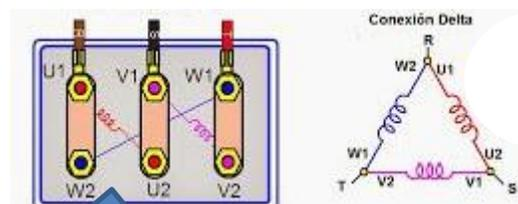
Como último dato, al conectar un motor este produce un giro en su eje, para invertir el giro de un motor trifásico solo se deben intercambiar entre sí, dos de sus tres fases. Esto ocasiona automáticamente un giro en sentido contrario.
