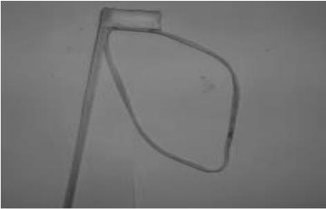
3.- Tomas el alambre (clip) y le das forma de gancho, con esto sostendremos el peso del dinamómetro
