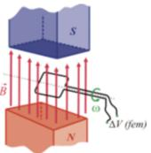
De forma similar, si cambia la intensidad del campo magnético que fluye dentro de una espira o de una bobina, se genera una diferencia de potencial.
