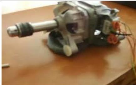
Existen otros de mayor tamaño y tienen más potencia que los anteriormente mencionados como, **Lavadoras, secadoras lavavajillas**, ... todos usan el poder de la rotación para realizar una tarea. **Recuerda que la unidad de medición de un motor es el caballo de fuerza que equivale a 746 watts de potencia**
