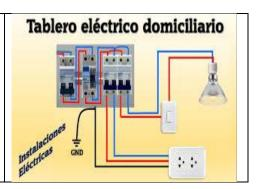
La función de sus dispositivos es controlar la instalación eléctrica y proteger tanto a las personas como a los aparatos que haya conectados a la red, como luminarias, artefactos y máquinas.
