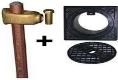
La **jabalina** suele tener media pulgada de espesor y, para instalarla, se debe perforar el suelo aproximadamente 1.0 a 1.5 mts. para introducirla.
